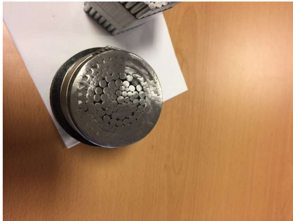
Un câble d'accrochage du HalogalandBrua
