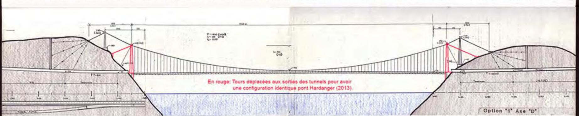
En rouge: Tours déplacées aux sorties des tunnels pour avoir une configuration identique pont Hardanger (2013)
