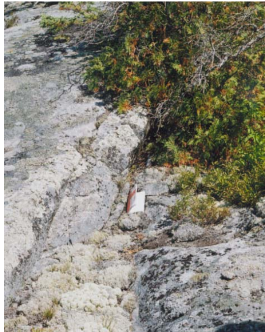
Photo 1-7 : Rive gauche : Grand affleurement de 40 m x 15 m environ. Localisation 361950E, 5334113N. ÉI. : 97 m. On notera qu'il y a trois systèmes de joints principaux dont un sub-perpendiculaire à la rivière Saguenay à pendage sub-vertical et l'autre sub-parallèle à la rivière Saguenay à pendage d'environ 70° vers la rivière.
